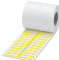
Etikett, Rolle, gelb, unbeschriftet, beschriftbar mit: THERMOMARK E.300 (D)/600 (D), THERMOMARK ROLL 2.0, THERMOMARK ROLL, THERMOMARK ROLL X1, THERMOMARK ROLLMASTER 300/600, THERMOMARK X1.2, Montageart: kleben, Anzahl der Einzelschilder: 10000, Textfeldhöhe: 7 mm, Textfeldbreite: 16 mm
