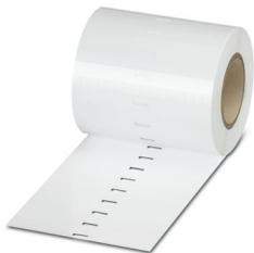
Marker für Klemmen, Rolle, weiß, unbeschriftet, beschriftbar mit: THERMOMARK ROLL 2.0, THERMOMARK ROLL, THERMOMARK ROLL X1, THERMOMARK ROLLMASTER 300/600, THERMOMARK X1.2, THERMOMARK S1.1, perforiert, Montageart: verrasten, verrasten in flacher Schildchennut, für Klemmenbreite: 6,2 mm, Anzahl der Einzelschilder: 16000, Textfeldhöhe: 6,35 mm, Textfeldbreite: 6,15 mm
