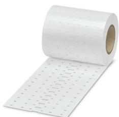
Kabelmarker, Rolle, weiß, unbeschriftet, beschriftbar mit: THERMOMARK E.300 (D)/600 (D), THERMOMARK ROLL 2.0, THERMOMARK ROLL, THERMOMARK ROLL X1, THERMOMARK ROLLMASTER 300/600, THERMOMARK X1.2, Kabeldurchmesserbereich: 1 ... 2,4 mm, Montageart: aufschieben, Anzahl der Einzelschilder: 4000, Textfeldhöhe: 4,2 mm, Textfeldbreite: 15 mm
