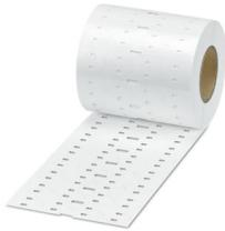
Kabelmarker, Rolle, weiß, unbeschriftet, beschriftbar mit: THERMOMARK E.300 (D)/600 (D), THERMOMARK ROLL 2.0, THERMOMARK ROLL, THERMOMARK ROLL X1, THERMOMARK ROLLMASTER 300/600, THERMOMARK X1.2, Montageart: Kabelbindermontage, Kabeldurchmesser:  $\geq 6$  mm, Anzahl der Einzelschilder: 4000, Textfeldhöhe: 8 mm, Textfeldbreite: 24 mm
