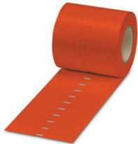
Einsteckschild, Rolle, rot, unbeschriftet, beschriftbar mit: THERMOMARK E.300 (D)/600 (D), THERMOMARK ROLL 2.0, THERMOMARK ROLL, THERMOMARK ROLL X1, THERMOMARK ROLLMASTER 300/600, THERMOMARK X1.2, Kabeldurchmesserbereich: 0,6 ... 50 mm, Montageart: einschieben, Anzahl der Einzelschilder: 7500, Textfeldhöhe: 4 mm, Textfeldbreite: 15 mm
