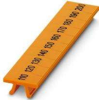
Zackband, Streifen, orange, beschriftet, längs bedruckt: Dekaden 110-200, Montageart: verrasten in hoher Schildchennut, für Klemmenbreite: 5,2 mm, Anzahl der Einzelschilder: 10
