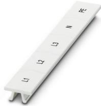
Zackband, Streifen, weiß, beschriftet, längs bedruckt: L1, L2, L3, N, PE, Montageart: verrasten, für Klemmenbreite: 15,2 mm, Anzahl der Einzelschilder: 5, Textfeldhöhe: 10,5 mm, Textfeldbreite: 15,1 mm
