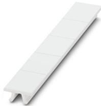
Zackband, Streifen, weiß, unbeschriftet, beschriftbar mit: PLOTMARK, CMS-P1-PLOTTER, Montageart: verrasten, für Klemmenbreite: 15,2 mm, Anzahl der Einzelschilder: 5, Textfeldhöhe: 10,5 mm, Textfeldbreite: 15,1 mm
