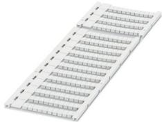
Zackbandmatte, Matte, weiß, unbeschriftet, beschriftbar mit: CMS-P1-PLOTTER, Montageart: verrasten, für Klemmenbreite: 5,2 mm, Anzahl der Einzelschilder: 160, Textfeldhöhe: 6,9 mm, Textfeldbreite: 5,15 mm
