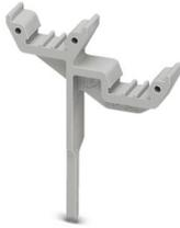
Schildchenträger, einrastbar in Zugfederklemmen ST 1,5..., beschriftbar mit UC-TM 4, UC-TMF 4, UCT-TM 4, UCT-TMF 4, ZB 4 oder ZBF 4, grau, unbeschriftet, Montageart: stecken, Textfeldhöhe: 10,5 mm, Textfeldbreite: 4 mm
