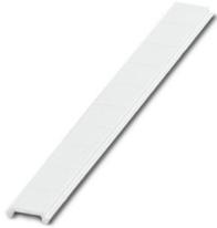
Zackband flach, Streifen, weiß, unbeschriftet, beschriftbar mit: PLOTMARK, CMS-P1-PLOTTER, Montageart: verrasten, für Klemmenbreite: 6,2 mm, Anzahl der Einzelschilder: 10, Textfeldhöhe: 6,15 mm, Textfeldbreite: 5,15 mm
