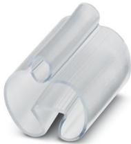
Ader-Bezeichnungsträger, transparent, unbeschriftet, Kabeldurchmesserbereich: 10 ... 14 mm, Montageart: aufschieben, Textfeldhöhe: 4 mm, Textfeldbreite: 23 mm
