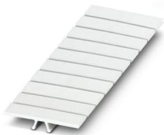
Zackband, Streifen, weiß, unbeschriftet, beschriftbar mit: CMS-P1-PLOTTER, Montageart: verrasten, für Klemmenbreite: 8,2 mm, Anzahl der Einzelschilder: 10, Textfeldhöhe: 10,5 mm, Textfeldbreite: 8,15 mm
