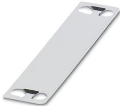
Kabelmarker, Edelstahlschild, silberfarben, unbeschriftet, Kabeldurchmesserbereich: 1 ... 63 mm, Montageart: Kabelbindermontage, Anzahl der Einzelschilder: 1, Textfeldhöhe: 19 mm, Textfeldbreite: 65 mm
