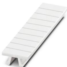
Zackband, Streifen, weiß, unbeschriftet, beschriftbar mit: PLOTMARK, CMS-P1-PLOTTER, Montageart: verrasten, für Klemmenbreite: 4,2 mm, Anzahl der Einzelschilder: 10, Textfeldhöhe: 10,5 mm, Textfeldbreite: 4,2 mm
