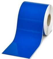
Etikett, hochflexibel, Rolle, blau, unbeschriftet, beschriftbar mit: THERMOMARK E.300 (D)/600 (D), THERMOMARK ROLL 2.0, THERMOMARK ROLL, THERMOMARK ROLL X1, THERMOMARK ROLMASTER 300/600, THERMOMARK X1.2, Montageart: kleben, Anzahl der Einzelschilder: 1, Rollenlänge: 48 m, Textfeldhöhe: 108 mm, Textfeldbreite: 48000 mm
