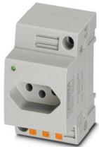
Steckdose, mit Leuchtanzeige, Steckgesicht Typ N, Anschlussart: Push-in-Federanschluss, Farbe: grau, Nennspannung: 250 V AC (50 Hz ... 60 Hz), Nennstrom: 10 A, zur Montage auf Tragschiene im Service-Interface oder Direktmontage, Länderkennzeichen: Brasilien
