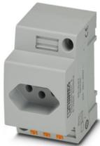
Steckdose, für Brasilien / Südafrika und weitere Länder, Steckgesicht Typ N, Anschlussart: Push-in-Federanschluss, Farbe: grau, Nennspannung: 250 V AC (50 Hz ... 60 Hz), Nennstrom: 10 A, zur Montage auf Tragschiene im Service-Interface oder Direktmontage, Länderkennzeichen: Brasilien
