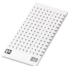
Kennzeichnungskarte, selbstklebend, längs bedruckt mit den fortlaufenden Zahlen: 1 ... 10, 10-teiliger Kennzeichnungsstreifen mit 14 gleichen Dekaden, weiß, für Klemmenbreite: 3,81 mm, Montageart: kleben
