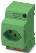
Steckdose, für Schweiz und weitere Länder, Steckgesicht Typ J, Anschlussart: Push-in-Federanschluss, Farbe: grün, Nennspannung: 250 V AC (50 Hz), Nennstrom: 16 A, zur Montage auf Tragschiene im Service-Interface oder Direktmontage, Normen/Bestimmungen: SEV 1011, Länderkennzeichen: Schweiz
