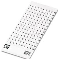
Kennzeichnungskarte, Bogen, weiß, längs bedruckt: fortlaufende Zahlen von 71 ... 80, Montageart: kleben, für Klemmenbreite: 3,5 mm, Anzahl der Einzelschilder: 14, Textfeldhöhe: 2,8 mm, Textfeldbreite: 3,5 mm
