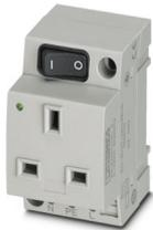
Steckdose, mit erweitertem Berührungsschutz / Shutter, Leuchtanzeige, Steckgesicht Typ G, Anschlussart: Schraubanschluss, Farbe: grau, Nennspannung: 250 V AC (50 Hz), Nennstrom: 13 A, Tragschienen- und Direktmontage, Normen/Bestimmungen: BS 1363-2, Länderkennzeichen: Großbritannien
