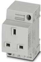
Steckdose, mit erweitertem Berührungsschutz / Shutter, Steckgesicht Typ G, Anschlussart: Schraubanschluss, Farbe: grau, Nennspannung: 250 V AC (50 Hz), Nennstrom: 13 A, zur Montage auf Tragschiene im Service-Interface oder Direktmontage, Normen/Bestimmungen: BS 1363-2, IEC 60884-1, Länderkennzeichen: Großbritannien
