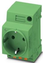
Steckdose, mit Leuchtanzeige, Steckgesicht Typ CF, Anschlussart: Push-in-Federanschluss, Farbe: grün, Nennspannung: 250 V AC (50 Hz), Nennstrom: 16 A, zur Montage auf Tragschiene im Service-Interface oder Direktmontage, Normen/Bestimmungen: VDE 0620-1, IEC 60884-1, Länderkennzeichen: Deutschland
