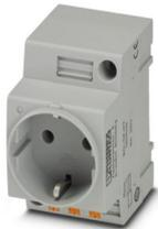
Steckdose, Steckgesicht Typ CF, Anschlussart: Push-in-Federanschluss, Farbe: grau, Nennspannung: 250 V AC (50 Hz), Nennstrom: 16 A, zur Montage auf Tragschiene im Service-Interface oder Direktmontage, Normen/Bestimmungen: VDE 0620-1, IEC 60884-1, Länderkennzeichen: Deutschland
