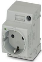
Steckdose, mit Leuchtanzeige, Steckgesicht Typ CF, Anschlussart: Schraubanschluss, Farbe: grau, Nennspannung: 250 V AC (50 Hz), Nennstrom: 16 A, zur Montage auf Tragschiene im Service-Interface oder Direktmontage, Normen/Bestimmungen: VDE 0620-1, IEC 60884-1, Länderkennzeichen: Deutschland
