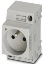
Steckdose, mit erweitertem Berührungsschutz / Shutter, Leuchtanzeige, Steckgesicht Typ E, Anschlussart: Schraubanschluss, Farbe: grau, Nennspannung: 250 V AC (50 Hz), Nennstrom: 16 A, zur Montage auf Tragschiene im Service-Interface oder Direktmontage, Normen/Bestimmungen: NF C61-314, IEC 60884-1, Länderkennzeichen: Frankreich
