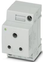
Steckdose, mit Leuchtanzeige, Typ: D, Anschlussart: Schraubanschluss, Farbe: grau, Nennspannung: 250 V AC (50 Hz), Nennstrom: 6 A, zur Montage auf Tragschiene im Service-Interface oder Direktmontage, Länderkennzeichen: Indien / Afrika
