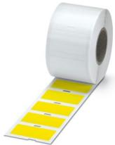
Etikett für raue Oberflächen, Rolle, gelb, unbeschriftet, beschriftbar mit: THERMOMARK E.300 (D)/600 (D), THERMOMARK ROLL 2.0, THERMOMARK ROLL, THERMOMARK ROLL X1, THERMOMARK ROLLMASTER 300/600, THERMOMARK X1.2, Montageart: kleben, Anzahl der Einzelschilder: 1000, Textfeldhöhe: 25 mm, Textfeldbreite: 51 mm
