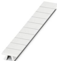
Zackband, Streifen, weiß, unbeschriftet, beschrifftbar mit: PLOTMARK, CMS-P1-PLOTTER, Montageart: verrasten, für Klemmenbreite: 7,5 mm, Anzahl der Einzelschilder: 10, Textfeldhöhe: 10,5 mm, Textfeldbreite: 7,4 mm
