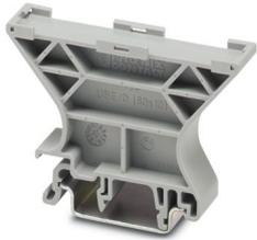
Klemmenleisten-Schildchenträger, für die Kennzeichnung von Klemmengruppen, zur Montage auf die Klemmenleiste NS 32 oder NS 35/7,5, Schriftfeldgröße: 60 x 10 mm
