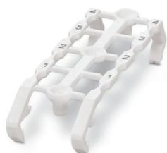
Marker für Klemmen, Streifen, weiß, beschriftet, Montageart: verrasten, für Klemmenbreite: 4 mm, Anzahl der Einzelschilder: 8, Textfeldhöhe: 9,2 mm, Textfeldbreite: 2,4 mm
