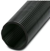
Schutzschlauch, Material: PA 6, UV-beständig: ja, flexibel, Schutzart: IP68, Farbe: schwarz, Brennbarkeitsklasse nach UL 94: V0, Innendurchmesser: 48 mm, Gesamtlänge: 25 m
