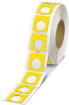
Kunststoffschild mit Bohrung, Rolle, gelb, unbeschriftet, beschriftbar mit: THERMOMARK E.300 (D)/600 (D), THERMOMARK ROLL 2.0, THERMOMARK ROLL, THERMOMARK ROLL X1, THERMOMARK ROLLMASTER 300/600, THERMOMARK X1.2, Montageart: kleben, Anzahl der Einzelschilder: 500, Textfeldhöhe: 10 mm, Textfeldbreite: 45 mm
