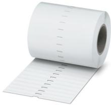
Kennzeichnungstreifen, Rolle, weiß, unbeschriftet, beschriftbar mit: THERMOMARK E.300 (D)/600 (D), THERMOMARK ROLL 2.0, THERMOMARK ROLL, THERMOMARK ROLL X1, THERMOMARK ROLLMASTER 300/600, THERMOMARK X1.2, Montageart: kleben, Anzahl der Einzelschilder: 2500, Textfeldhöhe: 3,8 mm, Textfeldbreite: 104 mm
