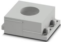
Kabeltülle, groß, Anzahl der Leitungen: 1, Ausführung: Rundkabel, geschlitzt, Leitungsaußendurchmesser: 1x 19 mm ... 20 mm, Material: SEBS (halogenfrei), Farbe: grau, Länge: 53 mm, Breite: 39 mm, Höhe: 17 mm
