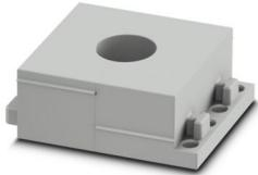
Kabeltülle, groß, Anzahl der Leitungen: 1, Ausführung: Rundkabel, geschlitzt, Leitungsaußendurchmesser: 1x 14 mm ... 15 mm, Material: SEBS (halogenfrei), Farbe: grau, Länge: 53 mm, Breite: 39 mm, Höhe: 17 mm
