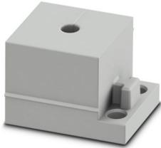
Kabeltülle, klein, Anzahl der Leitungen: 1, Ausführung: Rundkabel, geschlitz, Leitungsaußendurchmesser: 1x 5 mm ... 6 mm, Material: SEBS (halogenfrei), Farbe: grau, Länge: 29,5 mm, Breite: 19,5 mm, Höhe: 17 mm
