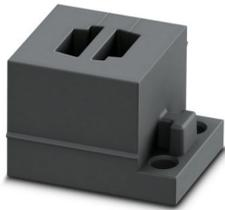
Kabeltülle, klein, Anzahl der Leitungen: 2, Ausführung: AS-i-Leitung (Rechts Rechts), geschlitz, Material: NBR, Farbe: schwarz, Länge: 29,5 mm, Breite: 19,5 mm, Höhe: 17 mm
