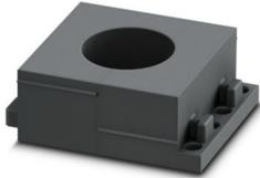
Kabeltülle, groß, Anzahl der Leitungen: 1, Ausführung: Rundkabel, geschlitzt, Leitungsaußendurchmesser: 1x 22 mm ... 23 mm, Material: NBR, Farbe: schwarz, Länge: 53 mm, Breite: 39 mm, Höhe: 17 mm
