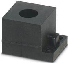
Kabeltülle, klein, Anzahl der Leitungen: 1, Ausführung: Rundkabel, geschlitzt, Leitungsaußendurchmesser: 1x 8 mm ... 9 mm, Material: NBR, Farbe: schwarz, Länge: 29,5 mm, Breite: 19,5 mm, Höhe: 17 mm
