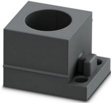
Kabeltülle, klein, Anzahl der Leitungen: 1, Ausführung: Rundkabel, geschlitzt, Leitungsaußendurchmesser: 1x 11 mm ... 12 mm, Material: NBR, Farbe: schwarz, Länge: 29,5 mm, Breite: 19,5 mm, Höhe: 17 mm
