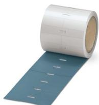
Einsteckschild, zur Kennzeichnung von Siemens-Steuerungen ET 200SP, Rolle, grau, unbeschriftet, beschriftbar mit: THERMOMARK E.300 (D)/600 (D), THERMOMARK ROLL 2.0, THERMOMARK ROLL, THERMOMARK ROLL X1, THERMOMARK ROLLMASTER 300/600, THERMOMARK X1.2, Montageart: einschieben, Anzahl der Einzelschilder: 500, Textfeldhöhe: 12,5 mm, Textfeldbreite: 31 mm
