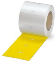
Einsteckschild, zur Kennzeichnung der Axioline F-Serie von Phoenix Contact, Rolle, gelb, unbeschriftet, beschriftbar mit: THERMOMARK E.300 (D)/600 (D), THERMOMARK ROLL 2.0, THERMOMARK ROLL, THERMOMARK ROLL X1, THERMOMARK ROLLMASTER 300/600, THERMOMARK X1.2, Montageart: einschieben, Anzahl der Einzelschilder: 500, Textfeldhöhe: 28 mm, Textfeldbreite: 35 mm
