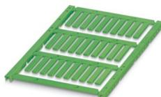
Leitermarker, Matte, grün, unbeschriftet, beschriftbar mit: BLUEMARK E.CARD, BLUEMARK ID COLOR, BLUEMARK ID, BLUEMARK CLED, THERMOMARK PRIME 2.0, THERMOMARK PRIME, THERMOMARK CARD 2.0, THERMOMARK CARD, TOPMARK NEO, TOPMARK LASER, Kabeldurchmesserbereich: 1,5 ... 35 mm, Montageart: einschieben, Anzahl der Einzelschilder: 30, Textfeldhöhe: 4 mm, Textfeldbreite: 23 mm
