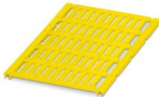
Leitermarker, Matte, gelb, unbeschriftet, beschriftbar mit: BLUEMARK E.CARD, BLUEMARK ID COLOR, BLUEMARK ID, BLUEMARK CLED, THERMOMARK PRIME 2.0, THERMOMARK PRIME, THERMOMARK CARD 2.0, THERMOMARK CARD, TOPMARK NEO, TOPMARK LASER, Kabeldurchmesserbereich: 0,6 ... 50 mm, Montageart: einschieben, Anzahl der Einzelschilder: 50, Textfeldhöhe: 4 mm, Textfeldbreite: 15 mm
