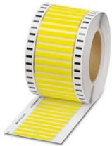
Schrumpfschlauch, Rolle, gelb, unbeschriftet, beschriftbar mit: THERMOMARK E.300 (D)/600 (D), THERMOMARK ROLLMASTER 300/600, THERMOMARK ROLL X1, THERMOMARK ROLL, THERMOMARK ROLL 2.0, THERMOMARK X1.2, Kabeldurchmesserbereich: 1,5 ... 3,2 mm, perforiert, Montageart: aufschieben, Anzahl der Einzelschilder: 4000, Textfeldhöhe: 5 mm, Textfeldbreite: 15 mm
