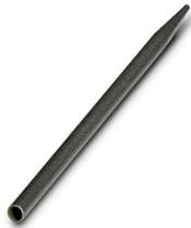
Auffädelhorn, erleichtert das Auffädeln der PMH auf den Leiter; Leiter in die Dornöffnung stecken und Hülsen auf den Leiter schieben. Für Leiteraußendurchmesser: 2,5-3,3 mm
