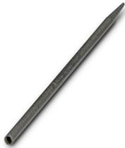
Auffädeldorn, erleichtert das Auffädeln der PMH auf den Leiter; Leiter in die Dornöffnung stecken und Hülsen auf den Leiter schieben. Für Leiteraußendurchmesser: 2,0-2,5 mm
