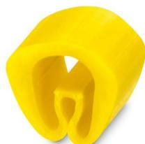
Leiterbezeichnungshülse, gelb, Kabeldurchmesserbereich: 3 ... 6 mm: ohne Aufdruck, Montageart: aufschieben, Textfeldhöhe: 2,6 mm, Textfeldbreite: 4,2 mm
